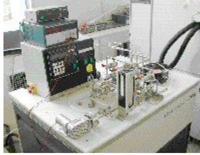
Fig.5 : Système d'étalonnage en humidité avec un banc générateur d'humidité
