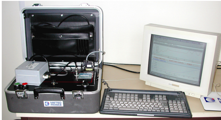
Fig.3 : Système d'étalonnage sur site en pression
