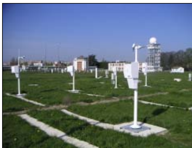
Photo 1 : Vue de 5 capteurs PWD22 (sur 8) en recette dans le parc DSO
