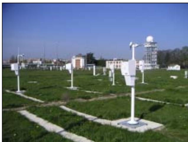
Photo 1 : Vue de 5 capteurs PWD22 (sur 8) en recette dans le parc DSO
