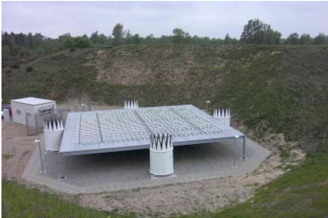
Fig.2(a) Deutsche Wetterdienst 482 MHz wind profile +RASS installed at Nordholz.
