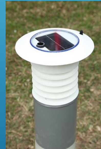
C 電燈桿上的微氣候監測儀器 20180827 10:08 Microclimate Sensors on a lamppost (9913)
