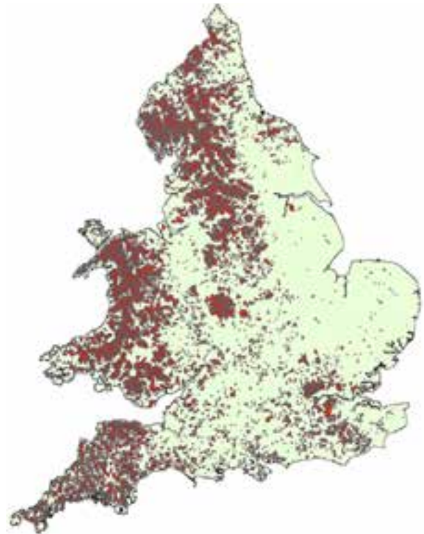
Figure 5.3. Les rivières et les bassins hydrographiques avec des temps de montée inférieurs à trois heures en Angleterre et au Pays de Galles.
