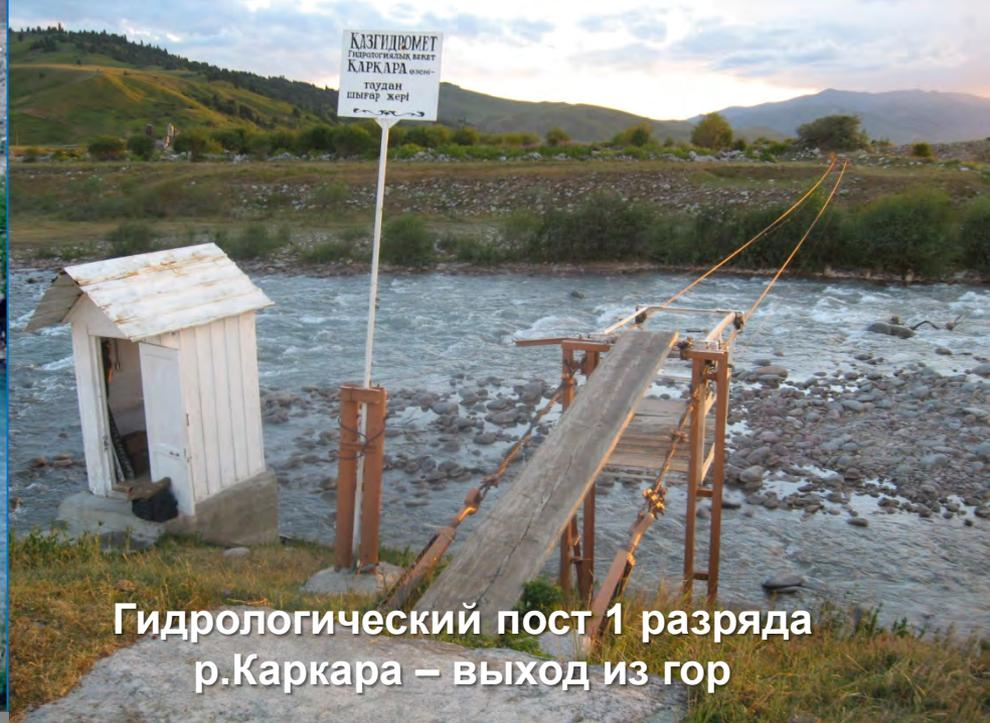
Гидрологический пост 1 разряда р.Каркара – выход из гор
