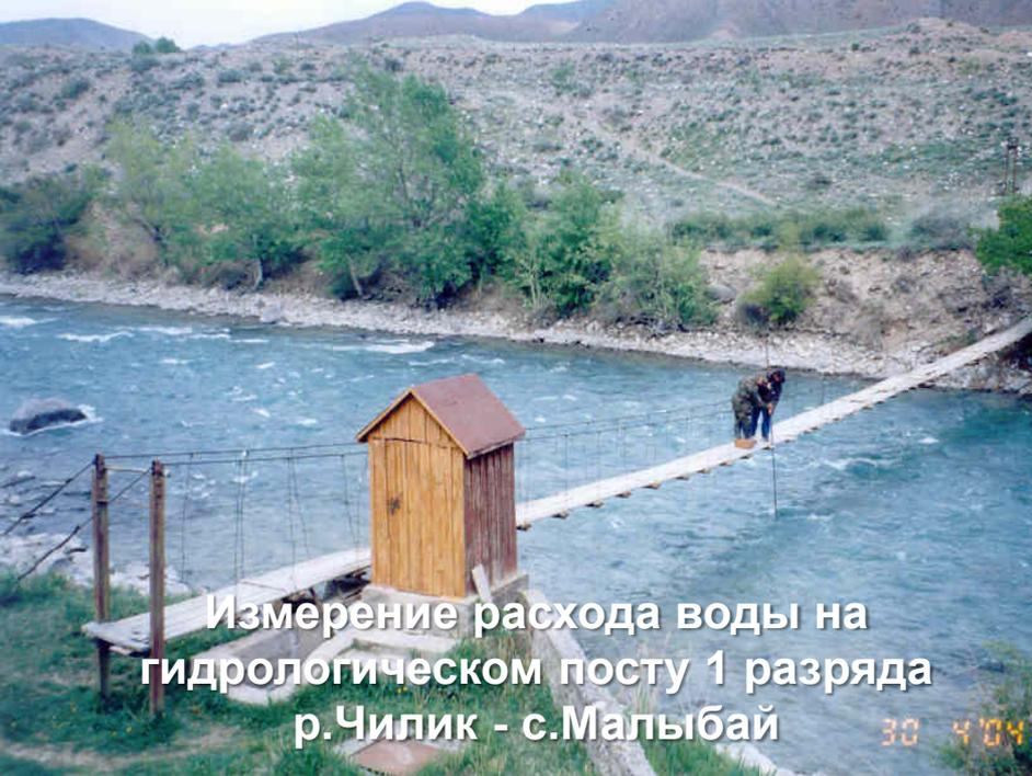
Измерение расхода воды на гидрологическом посту 1 разряда р.Чилик - с.Малыбай
