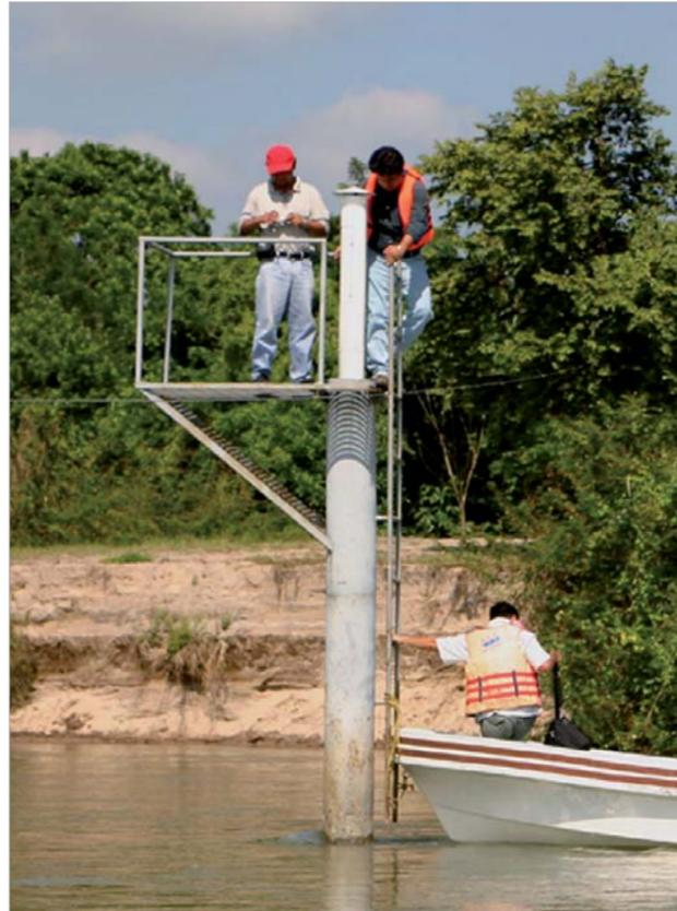
Les sondes Thalimedes installées dans les bassins fluviaux permettent de mesurer le niveau d'eau sur une base horaire (photo PROMMA).
