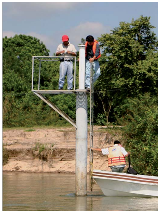
Los sensores Thalimedes instalados en las cuencas fluviales permite medir el nivel del agua con una base horaria (foto PROMMA).
