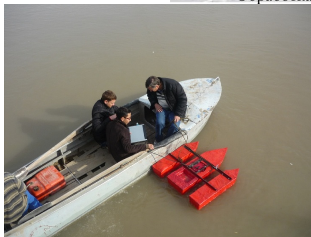
Измерение расхода воды с помощью доплеровского профилографа течений на ГП Иле – пристань Добын
