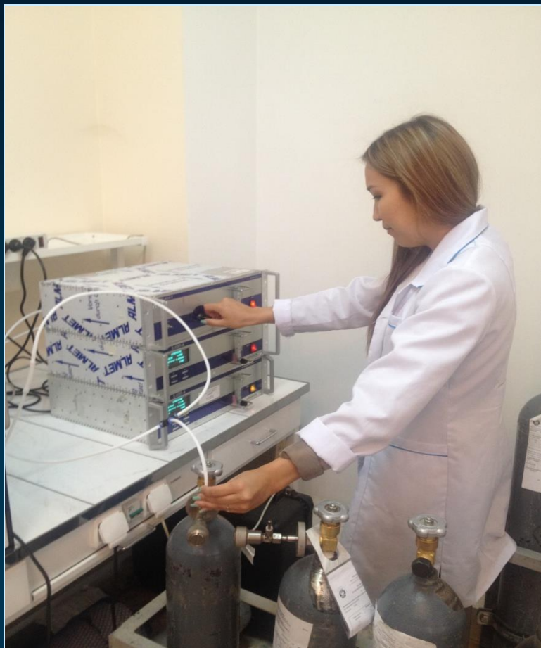
Рабочее место по поверке физико-химических измерений (газоанализаторов)
